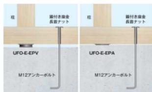
大型地震を震度5強へ分散免震
