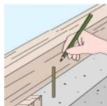
①土台下部からアンカーボルト用孔位置を漏出し
